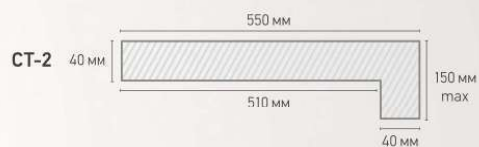
Ступени Г-образные 1200 (max) / 550 (max) /150 (max) / 40 мм
